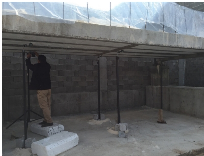
شکل ۸- دایال گیج و محل قرارگیری آن ها در آزمایش
